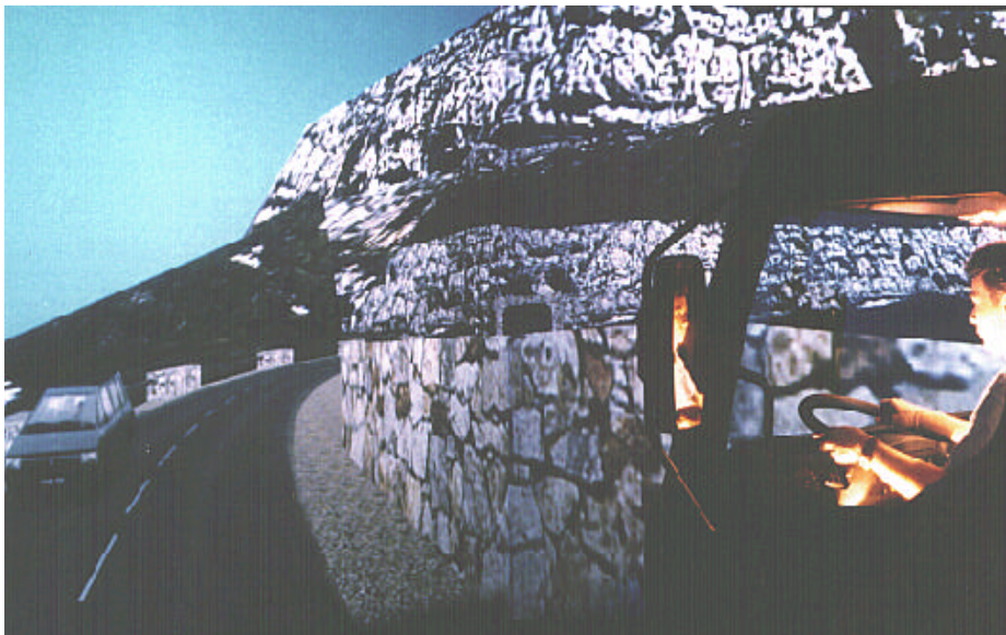
Simulateur dynamique RVI avec un champ de vision de 210°x50°
